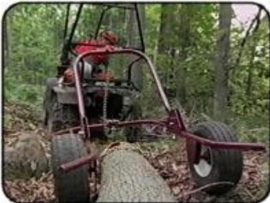
**3. Tendre la chaîne-élingue et coincer un maillon de celle-ci dans l'un des points d'attaches sur le dessus de l'arche.**
