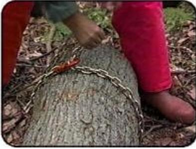
**2. Reculer l'arche jusqu'au billot (avec le VTT ou manuellement). L'arche doit toucher à la base du billot.**
