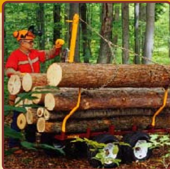
Mât de chargement avec chaîne en "V"
